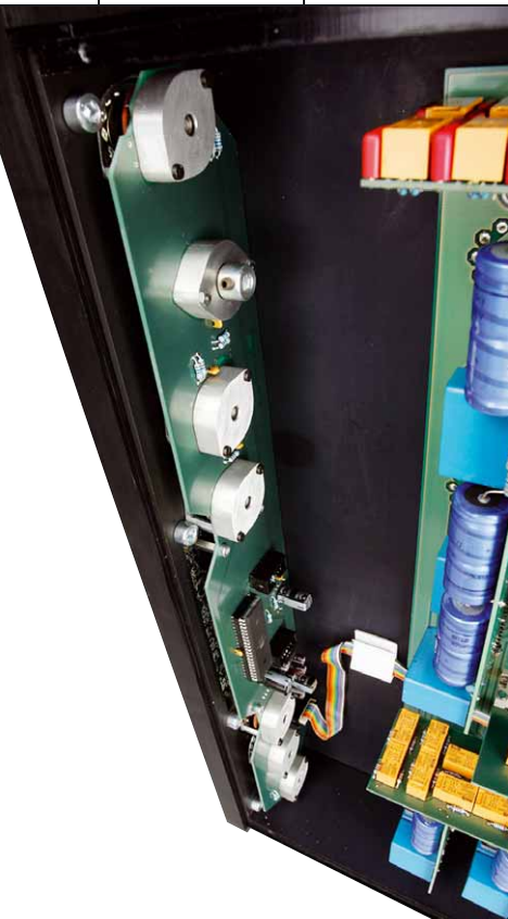
Sogar die Drehschalter sind weitgehend selbst gebaut
